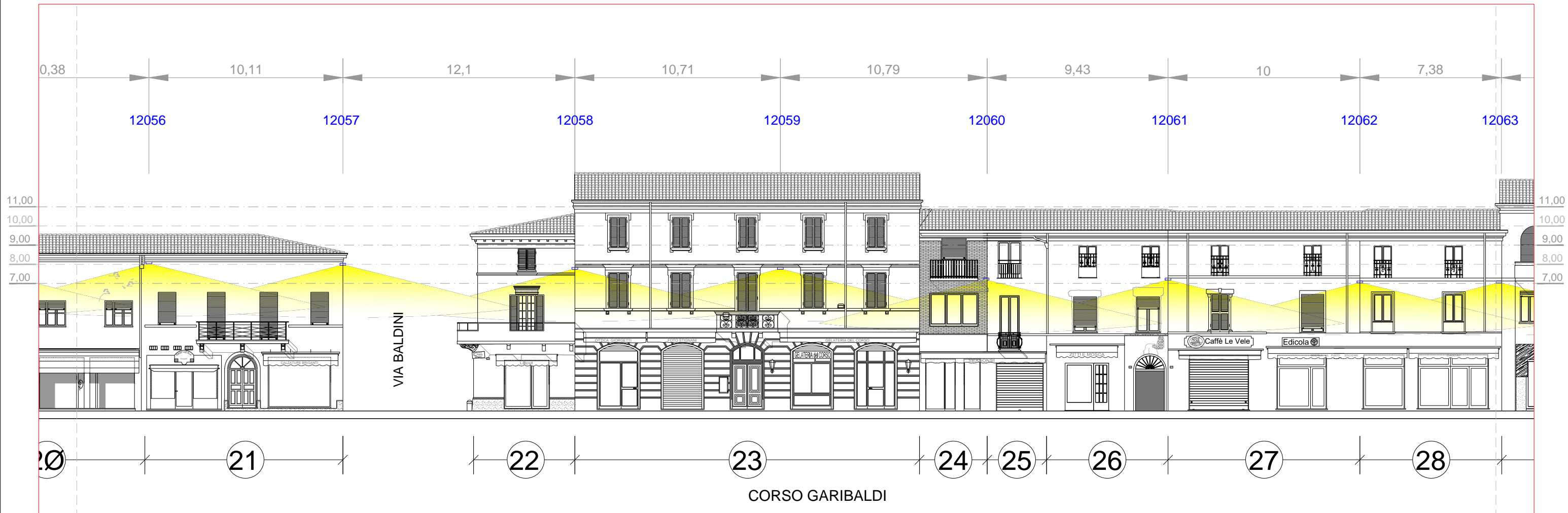
CORTINA BB'_LUNGO CANALE SUD_PORZIONE 4 CON POSIZIONAMENTI DEI CORPI ILLUMINANTI Scala 1:200
