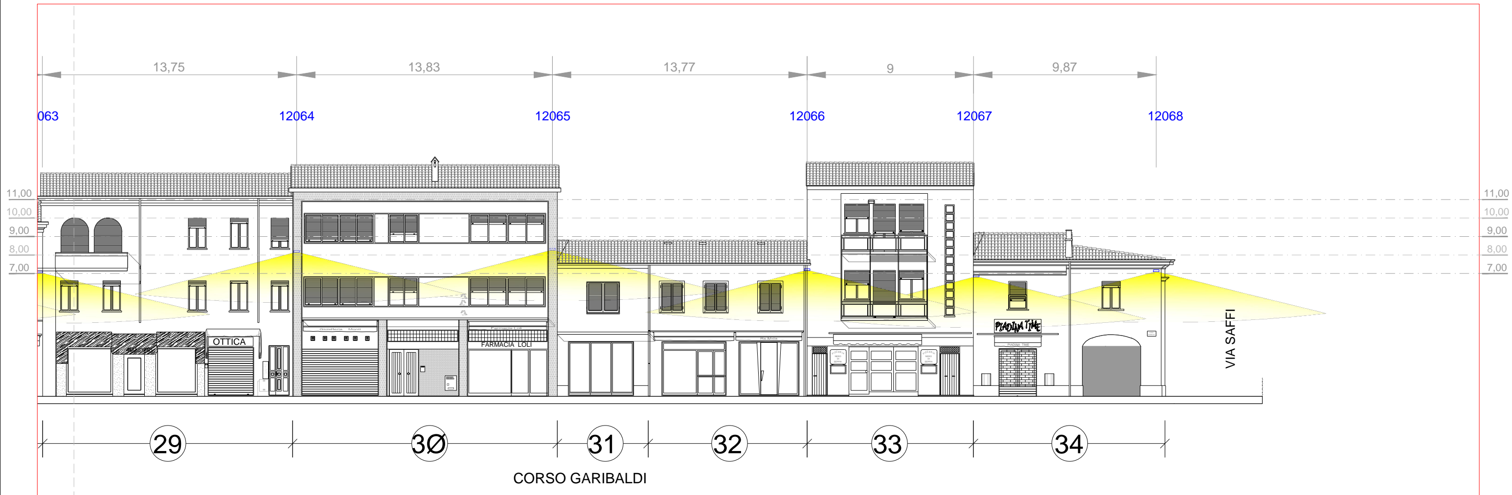
CORTINA BB'_LUNGO CANALE SUD_PORZIONE 5 CON POSIZIONAMENTI DEI CORPI ILLUMINANTI Scala 1:200
