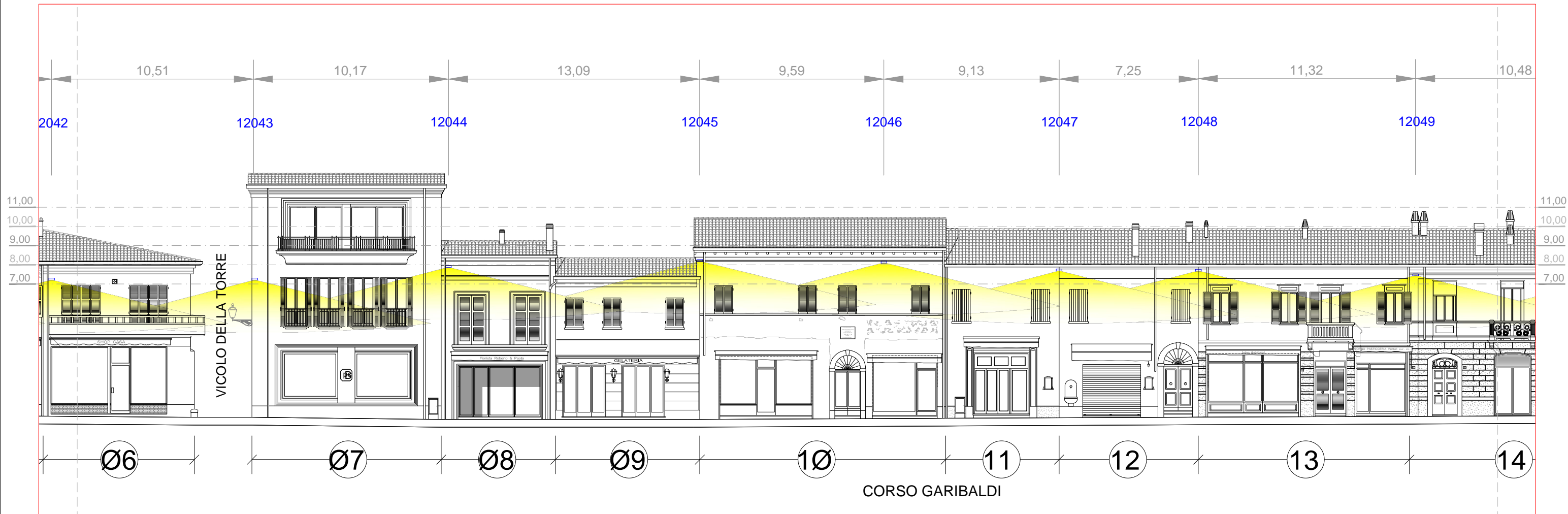
CORTINA BB'_LUNGO CANALE SUD_PORZIONE 2 CON POSIZIONAMENTI DEI CORPI ILLUMINANTI Scala 1:200
