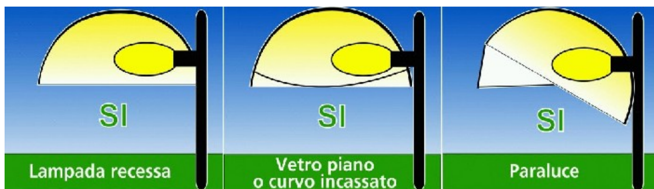
Fig. 2 - Tipologie di apparecchi conformi alla L.R. 19/2003
