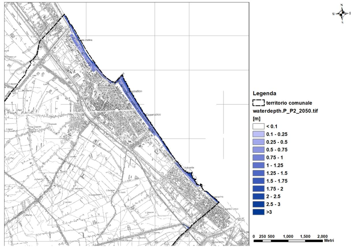
Figura 5 \_ Scenario di alluvionabilità costiera post-operam
