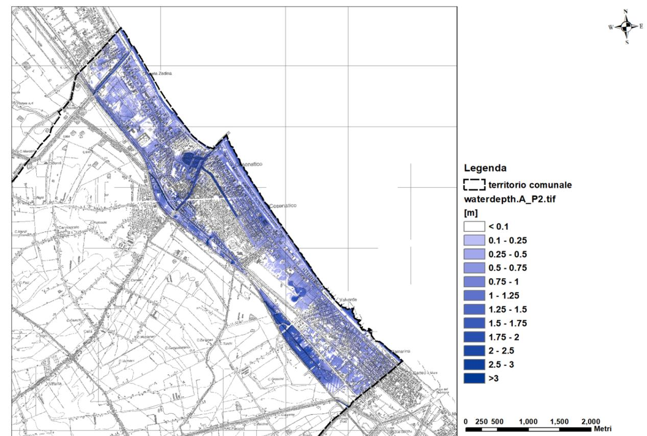
Figura 4 \_ Scenario di alluvionabilità costiera ante-operam
