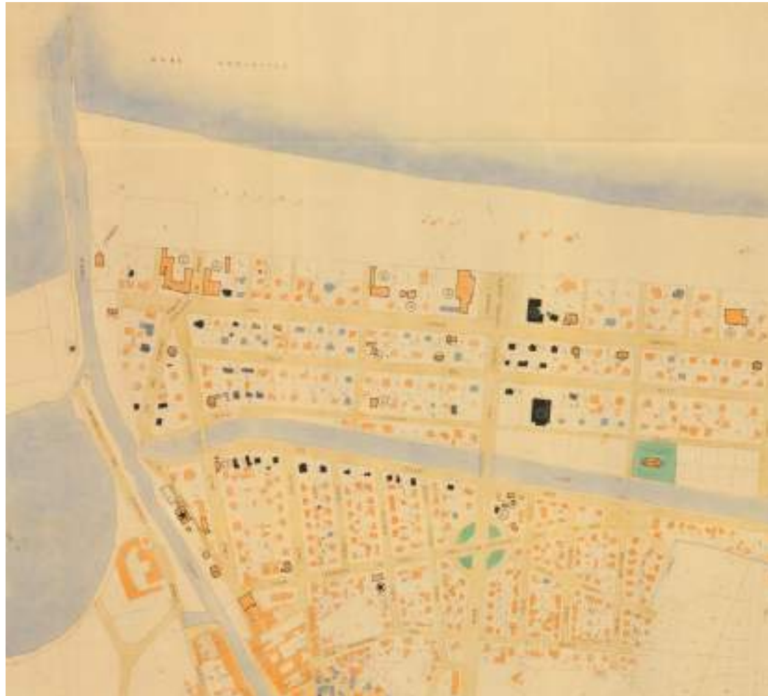
85 – Piano di ricostruzione di Cesenatico, Clemente Pedretti, 1950. Stato attuale, stralcio del foglio 2. Gli edifici in nero sono quelli crollati, in blu quelli semi crollati, in azzurro quelli lesionati, in arancione quelli intatti.
